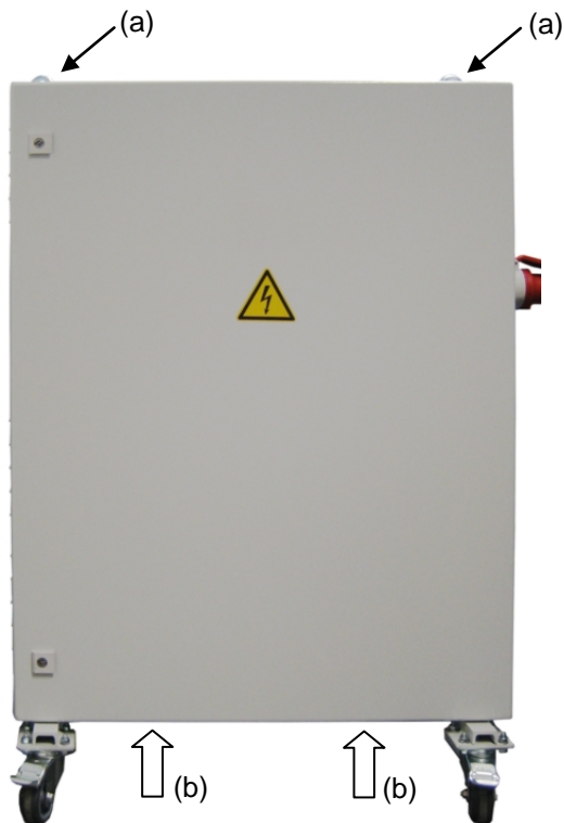
Rysunek 11: Pozycjonowanie środków pomocniczych do podnoszenia przetwornicy napięcia i częstotliwości
