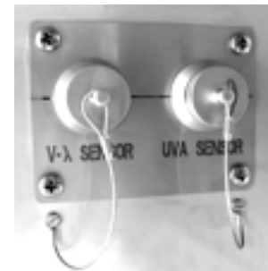
Rysunek 14: Złącza są zamknięte zaślepkami ochronnymi
