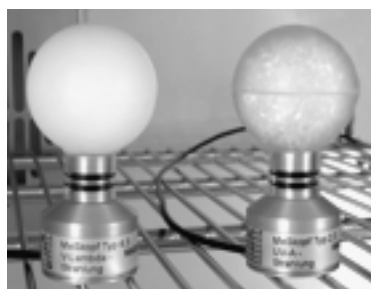
Rysunek 31: Sferyczne czujniki BINDER do pomiarów VIS i UVA
