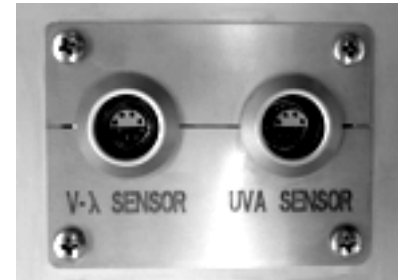
Rysunek 13: Złącza LEMO do podłączenia czujników światła
