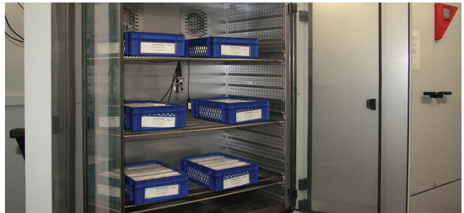
▲ Test stabilności produktu leczniczego w komorze klimatycznej do testów stabilności KBF
