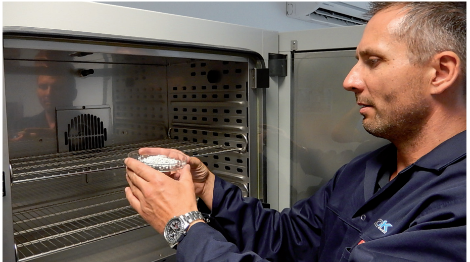
› 2. Załadunek tlenku glinu do komory klimatycznej do testów stabilności
