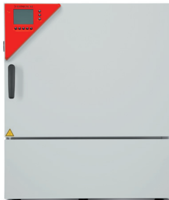
› 3. Komora klimatyczna do testów stabilności KBF 115
