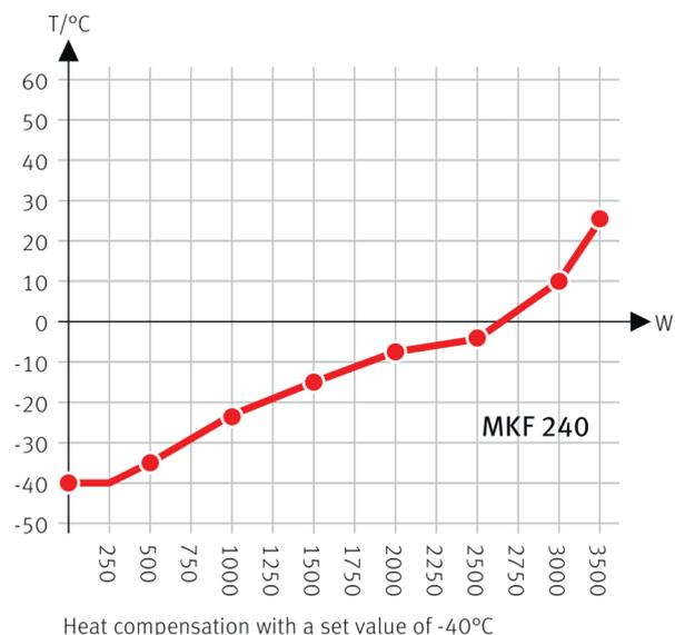
Esquema de compensación de calor
