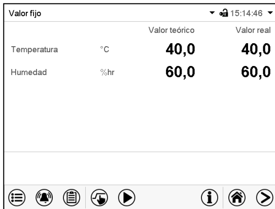
Vista inicial (valores reales / valores teóricos) (ejemplo KBF P / KBF P-UL o KBWF)
