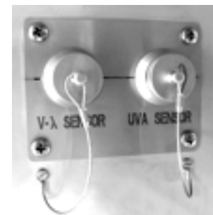
Figura 15: Tomas de conexión cerradas con las tapas de protección
