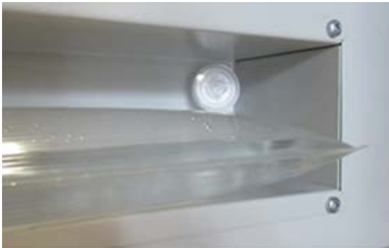
Figura 52: Posición del filtro fino de gas (filtro estéril) en el compartimento de la bolsa de agua dulce
