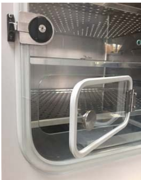
Figura 43: Puerta de vidrio (sección, ejemplo de tope de puerta a la derecha) con opción de acceso rápido a las muestras
