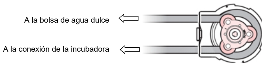
Figura 20: Inserción de la manguera de silicona en el cabezal de la bomba ④
