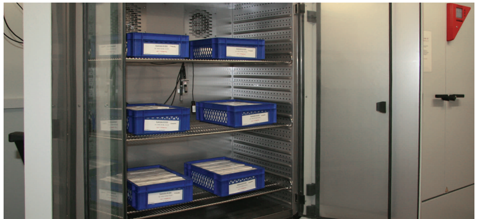
▲ Ensayo de estabilidad en medicamentos en una cámara de clima constante KBF
