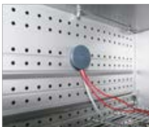
Puerto de acceso con tapón de silicona BINDER PURE AQUA Service
