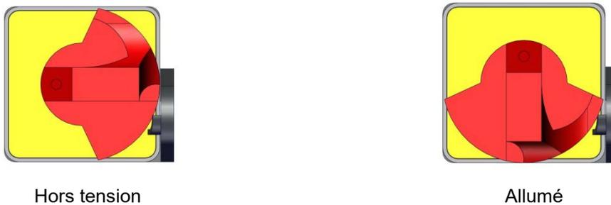
Figure 12: Interrupteur principal (4) situé au côté droit de l'appareil
