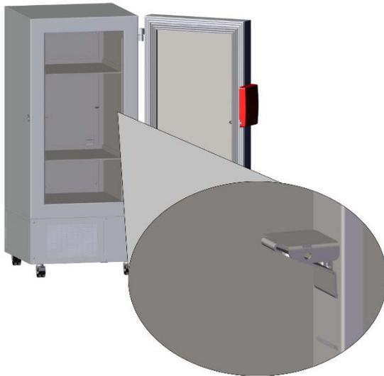
Figure 20: Insérer les supports de clayette
