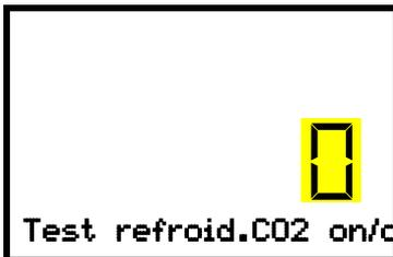
Réglage de la fonction 2 « Test refroid.CO2 on/off' ».
