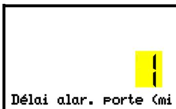
Réglage du délai d'alarme de porte ouverte.
