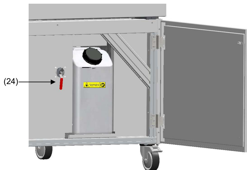
Figure 12: Levier pour le recyclage du condensé (position ouverte) à côté de la nourrice d'eau fraîche derrière la porte d'entretien
