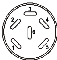
Figure 23: Occupation des pins de la douille de raccordement DIN (10) pour l'option Sorties analogiques d'humidité
