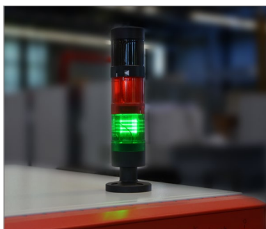
Affichage du déroulement du programme via lampe de signalisation
