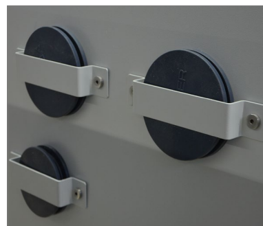
Sécurité du passage de câble en cas de surpression pour des conditions de test stables
