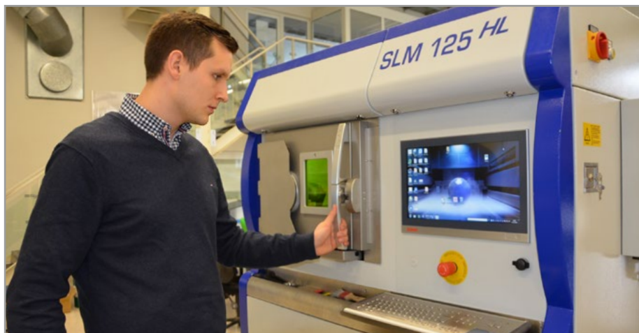
› Le principe de la fusion laser permet de fabriquer des composants légers, par exemple pour l'industrie aérospatiale.
