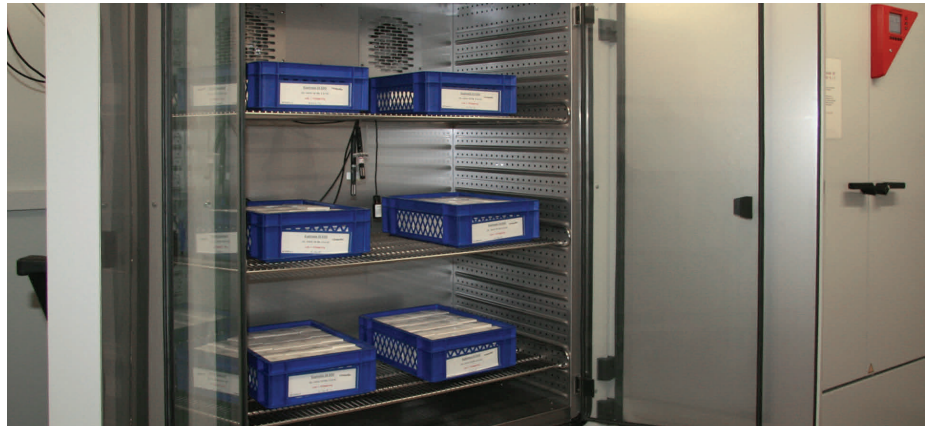
▲ Test de stabilité de médicaments dans une chambre climatique à conditions constantes KBF
