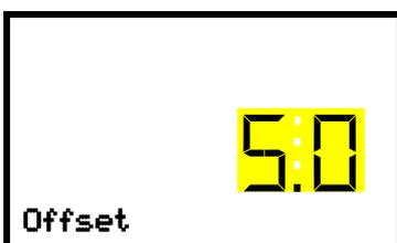
Réglage de la valeur du régulateur de sécurité avec le mode de régulateur de sécurité « Offset »
