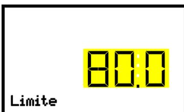
Réglage de la valeur du régulateur de sécurité avec le mode de régulateur de sécurité « Limite ».
