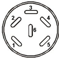
Figure 7: Occupation des pins de la douille de raccordement pour l'option Sortie analogique
