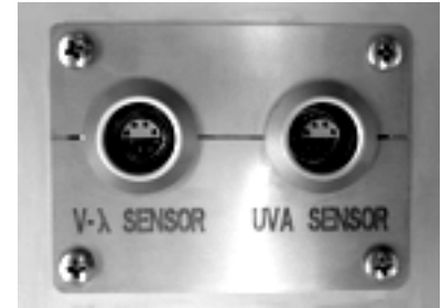
Figure 14: Prises Lemo pour la connexion des capteurs de lumière
