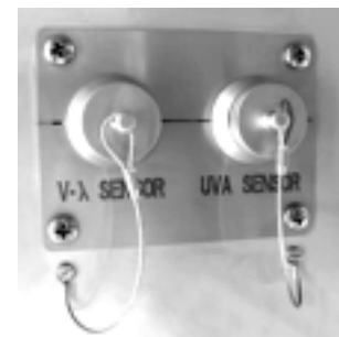
Figure 15: Prises de connexion fermées par des couvercles protecteurs
