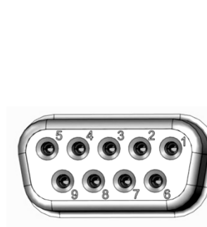
Figure 26: Douille SUB-D « Object temperature input » (9) pour la connexion du capteur Pt 100 optionnel dans le tableau de connexion au dos de l'appareil
