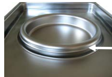
Figure 14: Appareils volumes 170 / 260, Hauteur de remplissage du bassin extérieur
