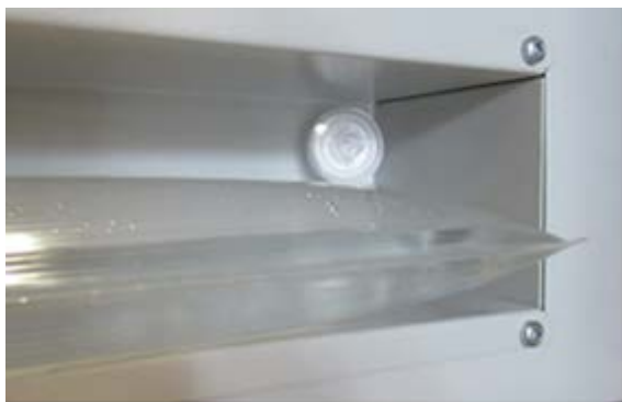
Figure 52: Position du filtre fin à gaz (filtre stérile) dans le recès pour le sac d'eau douce
