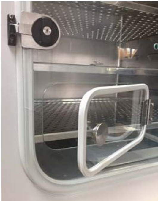
Figure 43: Porte en verre (détail, ex. butée de porte à droite) avec l'option d'accès rapide aux échantillons
