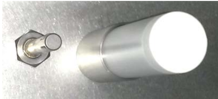
Figure 11: Détecteur de CO 2 (à droite) branché et tête de mélange de gaz CO 2
