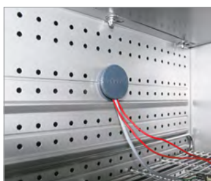
Port d'accès équipé d'un obturateur en Mode vibration dans l'enceinte silicone
