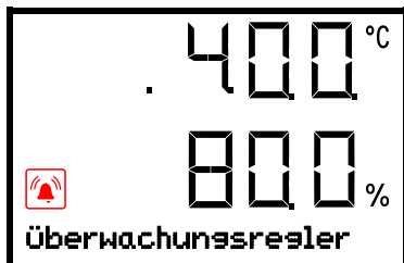
Alarmanzeige (Beispiel: Überwachungsregler-Alarm)
