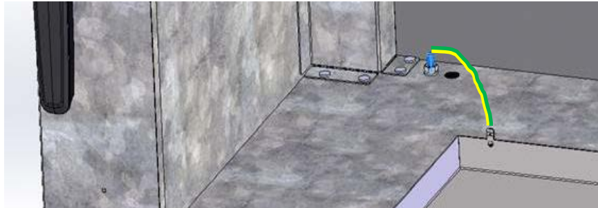
Abbildung 20: Erdungskabel zum Potenzialausgleich zwischen Kondensat-Auffangwanne und Pumpenschrank
