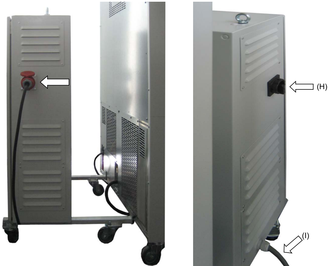
Linke Seite des Spannungs- und Frequenzumwandlers mit Anschlussdose (G) für Wechselklimaschrank
