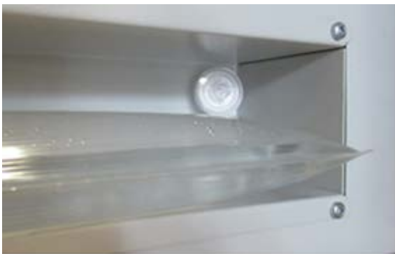
Abbildung 52: Position des Gas-Feinfilters (Sterilfilter) im Ablagefach des Frischwasserbeutels
