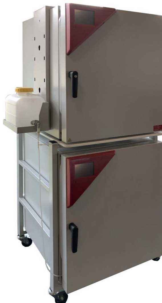
Abbildung 23: Zwei CBF / CBF UL-Geräte mit installierter Wasserversorgung über Frischwasserkarister (Option)
