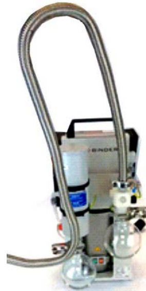
Vakuumpumpe mit angeschlossenem Schlauch
