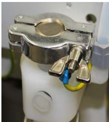
Anschluss mit Spannring und Blindkappe (Lieferzustand)
