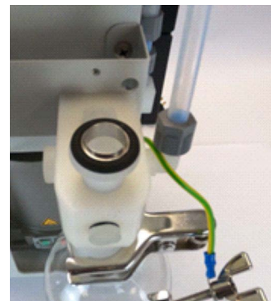
Anschluss mit Dichtung nach Abnehmen des Spannringes und der Blindkappe
