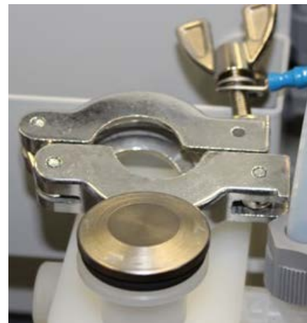
Anschluss mit Blindkappe nach Abnehmen des Spannrings
