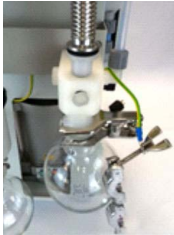
Aufsetzen des Vakuumschlauchs
