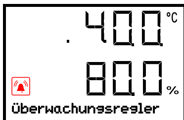
Alarmanzeige (Beispiel: Überwachungsregler-Alarm)
