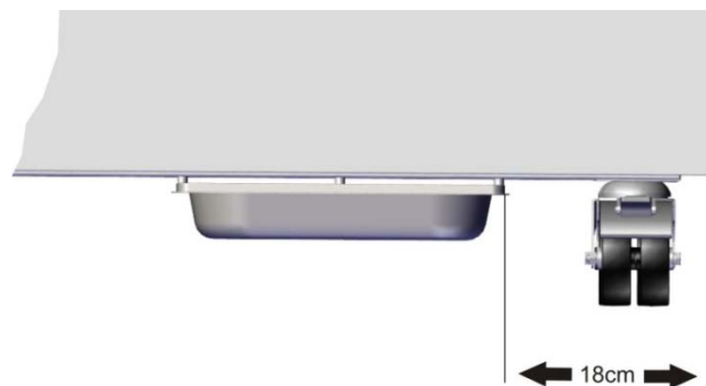
Abbildung 19: Positionierung der Kondensat-Auffangschale (Ansicht von vorn)
