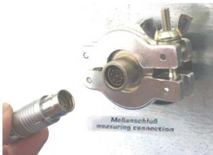
Abb. 25: Messstutzen (12) mit Messstromdurchführung
