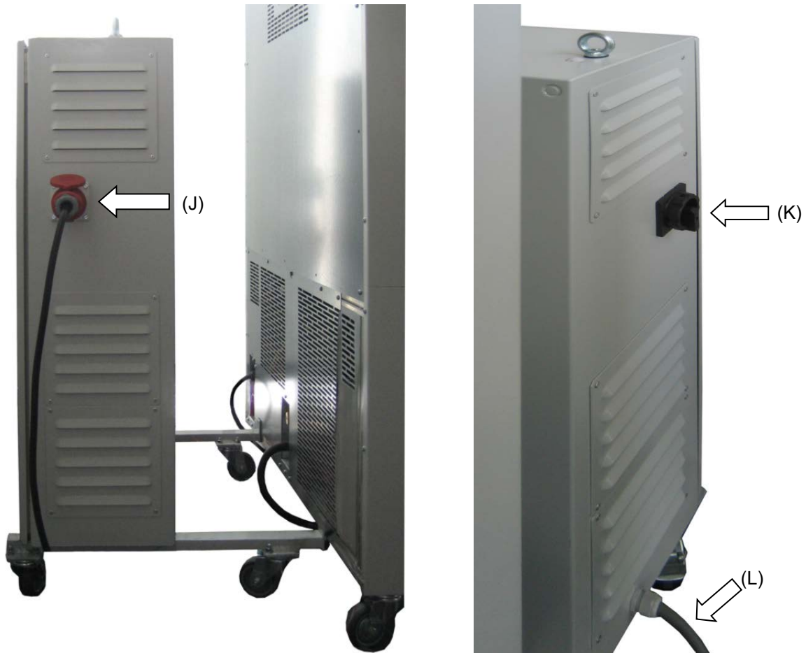
Linke Seite des Spannung- und Frequenzumwandlers mit Anschlussdose (J) für Batterietestschrank
