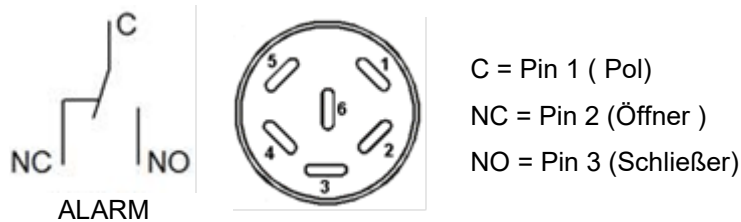
Abb. 16: Schaltbild der potenzialfreien Kontakte und Pinbelegung der DIN-Buchse (13)
