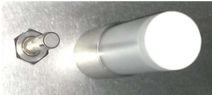
Abb. 11: Eingesteckter CO 2 -Sensor (rechts) und CO 2 Gasmischkopf
